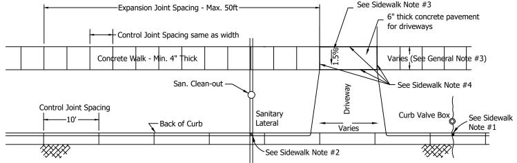
JOINT LOCATIONS - CONCRETE SIDEWALK N.T.S.
